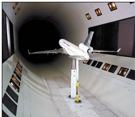
Figura 9. Modelo a escala en túnel de viento moderno. NASA
