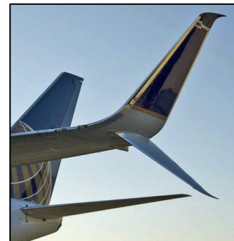
Figura 24. Ejemplo de "Split-Scimitar Winglet" [24]
