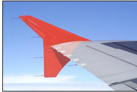
Figura 25. Ejemplo de " Wingtip fence " [24]
