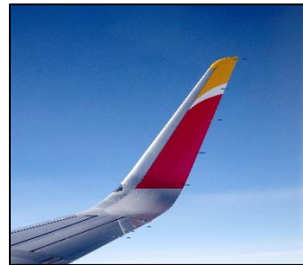
Figura 22. Ejemplo de "blended winglet" [23]
