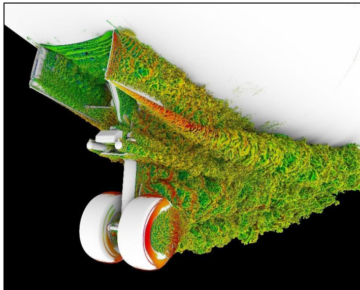
Figura 10. Ejemplo de software CFD actual. Flujo de aire en torno a un tren de aterrizaje. NASA Ames Research Center
