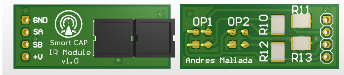
Figura 29: Vista superior e inferior del modelo 3D de la PCB del módulo IR.
