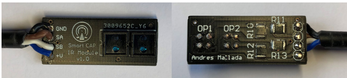
Figura 34: PCB módulo IR ya soldada.
