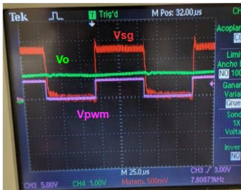
Figura 29-Tensiones en el buck con D=0.5
