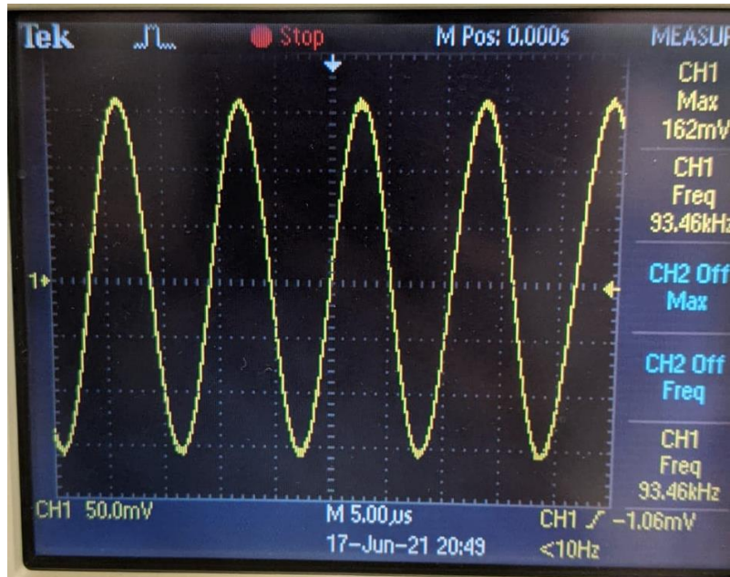
Figura 3-Corriente sinusoidal en la condición de resonancia del tanque LC, que atraviesa el solenoide aplicador de campo. El panel derecho muestra los valores de pico V=162 mV (que con la pinza amperimétrica utilizada corresponde a I=162 A) y la frecuencia f=93.46 kHz.
