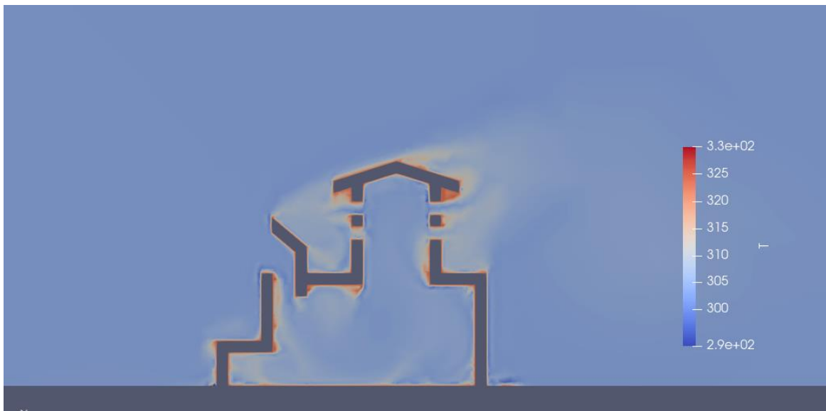
Anexo 6: Simulación Malla 1 Full Navier-Stokes Torre de Viento con el suelo adiabático
