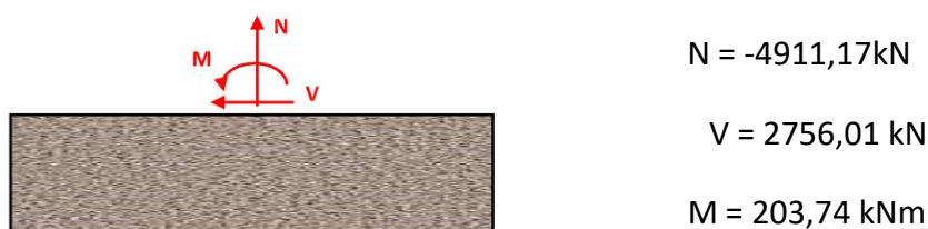
FIGURA 89. ESFUERZOS TOTALES EN ZAPATA
