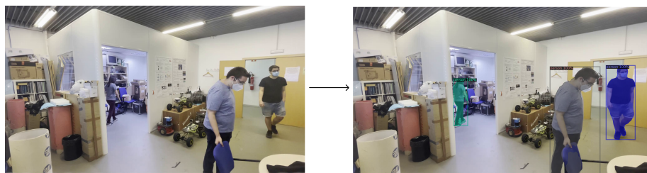
Figura 1.3: Ejemplo de detección: Salida del algoritmo de predicción Detectron2 sobre el dataset grabado en la EINA.
