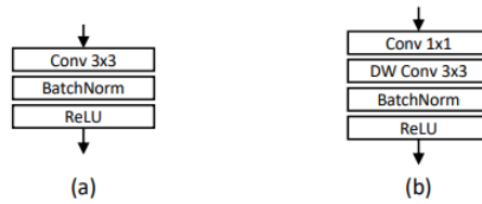
Figura 2.8: Ejemplo de cómo OsNet varía las capas convolucionales con lo que denominan Lite . (a) Standard 3×3 convolution. (b) Lite 3×3 convolution. DW: Depth-Wise. Fuente [6]
