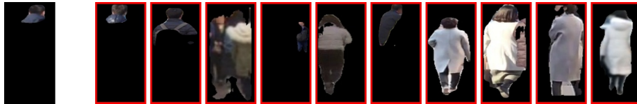
Figura 4.4: Ejemplo de segmentación de imágenes donde se elimina erróneamente parte de la persona a reconocer. A la izquierda se ve la query realizada al modelo, y a la derecha los 10 resultados que este ha obtenido para ella (verde si correcto y rojo si incorrecto). Fuente [21].
