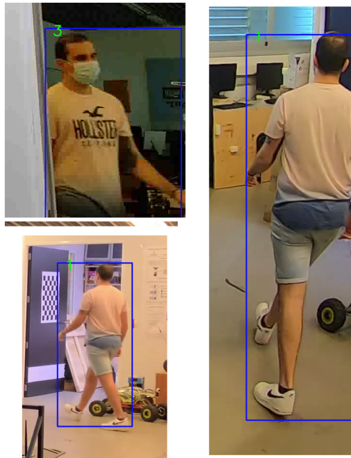
Figura 3.6: Ejemplo de situación en la que se re-identifica erróneamente una persona en una cámara, pero en las otras 2 del sistema se re-identifica correctamente.
