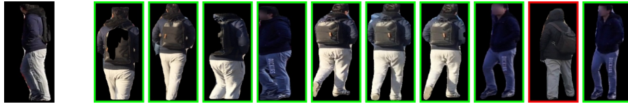
Figura 4.3: Ejemplo de segmentación de imágenes donde se ha re-identificado correctamente la persona objetivo. A la izquierda se ve la query realizada al modelo, y a la derecha los 10 resultados que este ha obtenido para ella (verde si correcto y rojo si incorrecto). Fuente [21].
