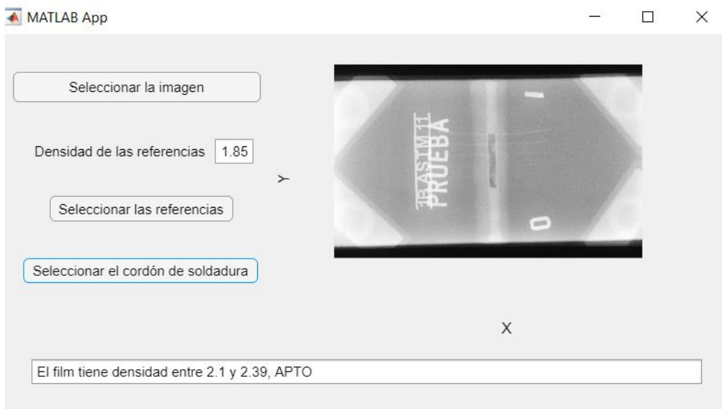
Ilustración 28. Obtención de la densidad del cordón
