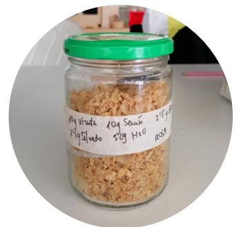
Mezcla del sustrato virutas con agua [Figura 27]
