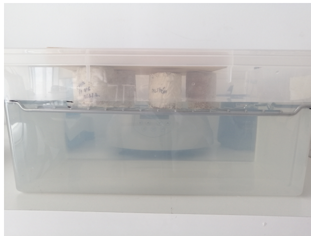
Muestras en el ensayo de absorción [Figura 33]
