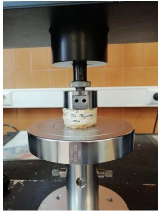
Algodón después de la compresión [Figura 49]
