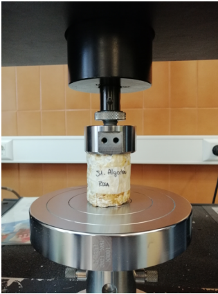
Algodón antes de la compresión [Figura 48]
