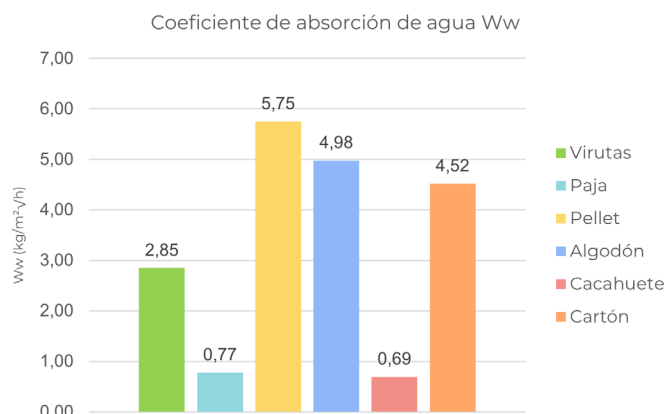
Valores medios del coeficiente de absorción de agua W_w [Figura 40]
