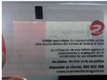
Imagen.3 – tarjeta tranvía con etiqueta RFID en su interior
