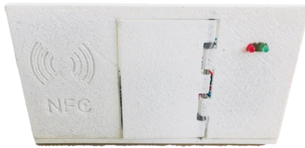
Figura 31: Dispositivo RFID ,Abierto(verde)/Cerrado(rojo)
