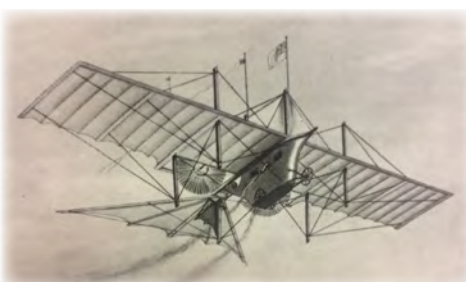
(Figs. 27 y 28) A la izquierda, Fig. 27, detalle de un grabado de 1843: el Aerial Steam Carriage proyectado por William Samuel Henson, de la Enciclopedia de aviación y astronáutica 1 consultada y registrada por el autor en su cuaderno, como muestra la Fig. 28 a su derecha.
