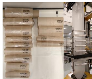
Figura 43: Muestras de film, ejemplos de formulaciones (izq) y prueba de soplado de film (dcha)
