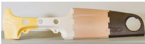
Figura 42: Prototipo de salpicadero elaborado con: colorante extraído del limón, fragancia de limón, cáscara de almendra y colorante extraído de la granada.
