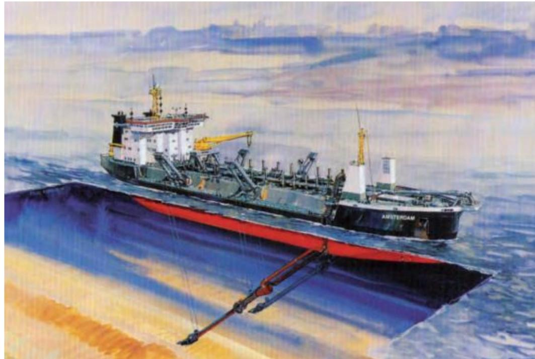
Ilustración 6 Ejemplo draga de succión en marcha
