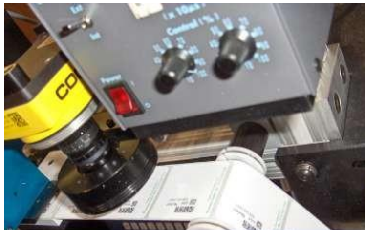
Ilustración 46. Sistema 2D analizando una cinta en movimiento (Introducción a la visión artificial, 2021)
