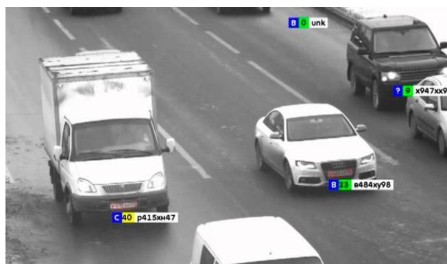
Ilustración 27. Cámara con reconocimiento de matrículas automático (Sistemas de Visión Artificial Industrial, 2020)
