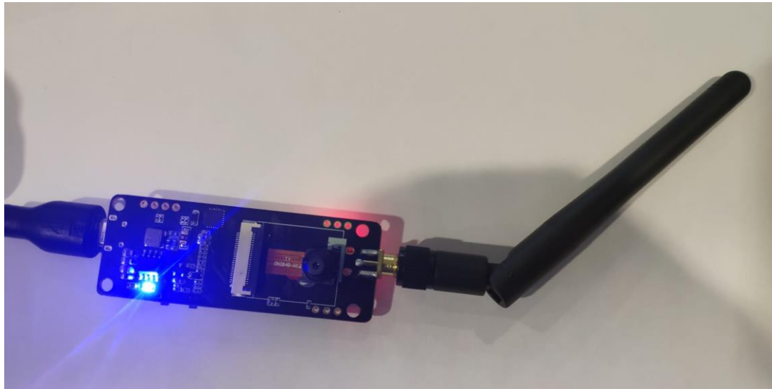
Ilustración 78. Módulo ESP-32 TTGO OV2640 en funcionamiento (Elaboración propia)
