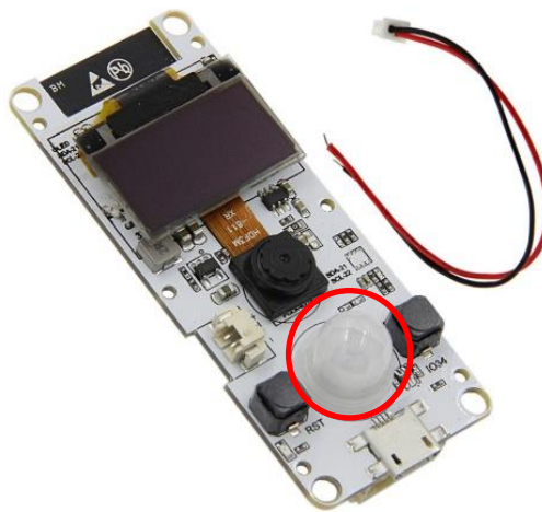
Ilustración 120. Rodeado en rojo, el sensor PIR incorporado en la placa ESP-32 (ESP32 TTGO T-Camera with PIR, 2021)
