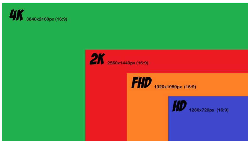
Ilustración 26. Comparación de píxeles que captan las diferentes resoluciones (Sistemas de Visión Artificial Industrial, 2020)
