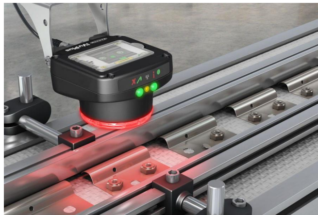
Ilustración 25. Cámara de visión artificial en una línea de producción automatizada (Sistemas de Visión Artificial Industrial, 2020)
