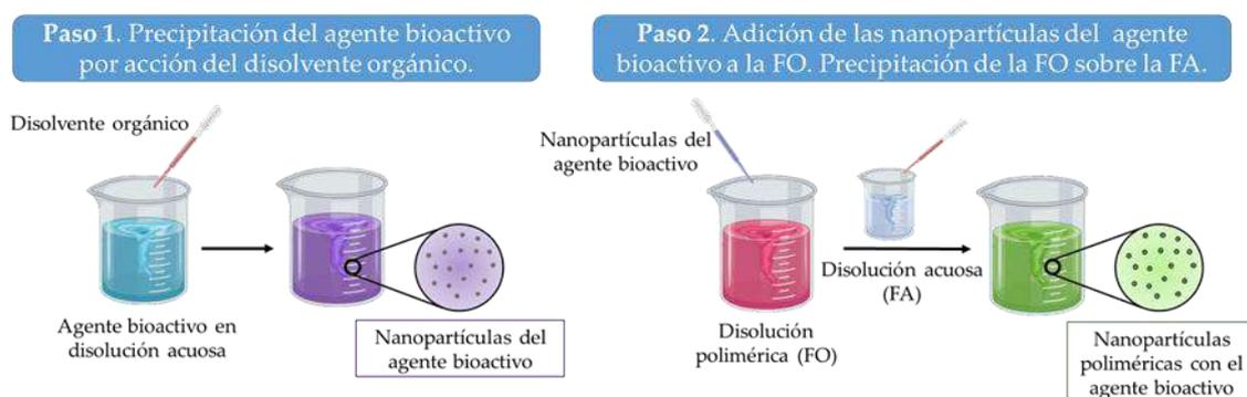
Figura 3.4 Esquema de la variación de la técnica de nanoprecipitación en dos pasos.
