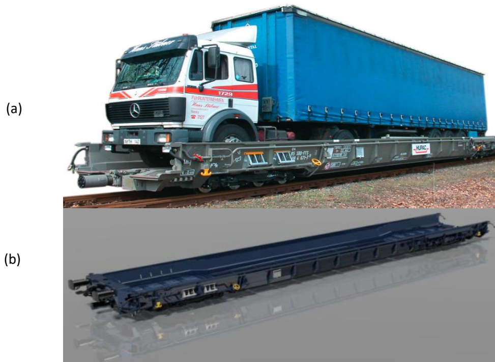
Figura IV.10. Vagón ROLA, modelo Saadkms: (a) cargado con un camión. Fuente: [50.A]; (b) renderizado. Fuente: [49.A].
