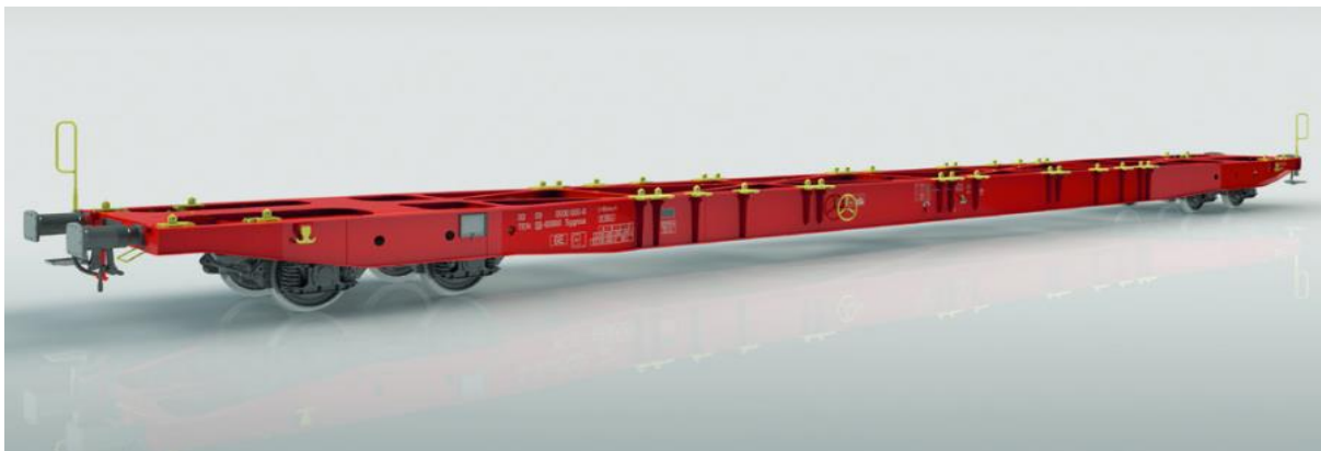
Figura IV.1. Vagón de piso alto o tradicional, modelo Sggnss 80", con su reflejo. Fuente: [42.A, p. 16].
