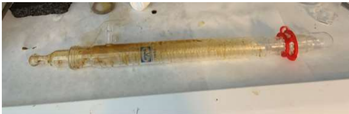
Figura 5: Condensador tras la realización de un experimento con componente mayoritario de lodos
