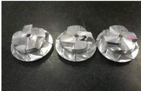
Figura 11. Diseño de la pieza patrón del artículo Identification of integrated geometric errors of rotary axis and setup position errors for 5-axis machine tools [9].
