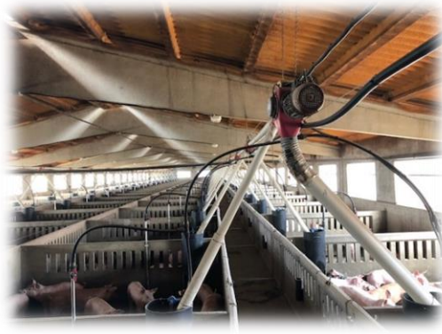
Ilustración 4: Transportador en espiral que empuja el pienso hacia cada comedero (Fotografía propia)
