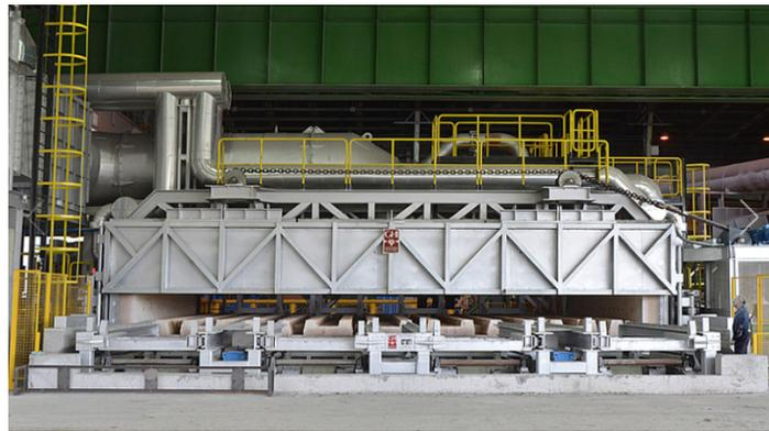
*Figuras 2.3. Horno tipo ATKINSON-STEIN, destinado a calentar tochos. En el alzado y planta se indican las partes principales de estos hornos: chimenea revestida de ladrillo, válvulas, ventilador de aire frío, recuperador, tuberías de aire caliente, salida de humos, y puertas de carga/descarga. También una imagen real de este horno.*
