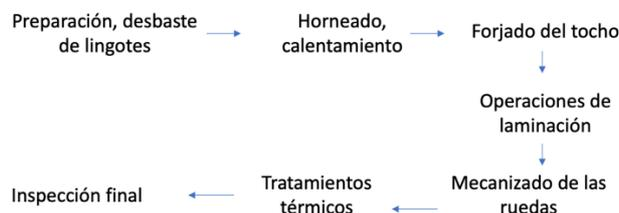
*Diagrama de bloques del proceso con prensa y laminador.*
