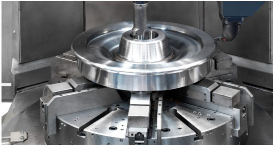
Figura 2.7. Mecanizado de rueda en un torno vertical DANOBAT TV-1500.
