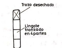
Figura 2.2. Lingote tronchado en cuatro partes.
