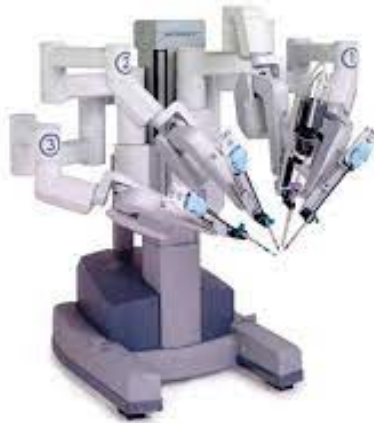
Figura A.4: Robot quirúrgico Da Vinci [4].
