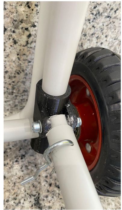
Detalles del eje y sus conexiones
