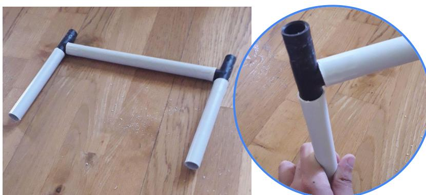
*Se colocan los codos sobre los perfiles cortados y se añade la barra horizontal en los salientes laterales.*
