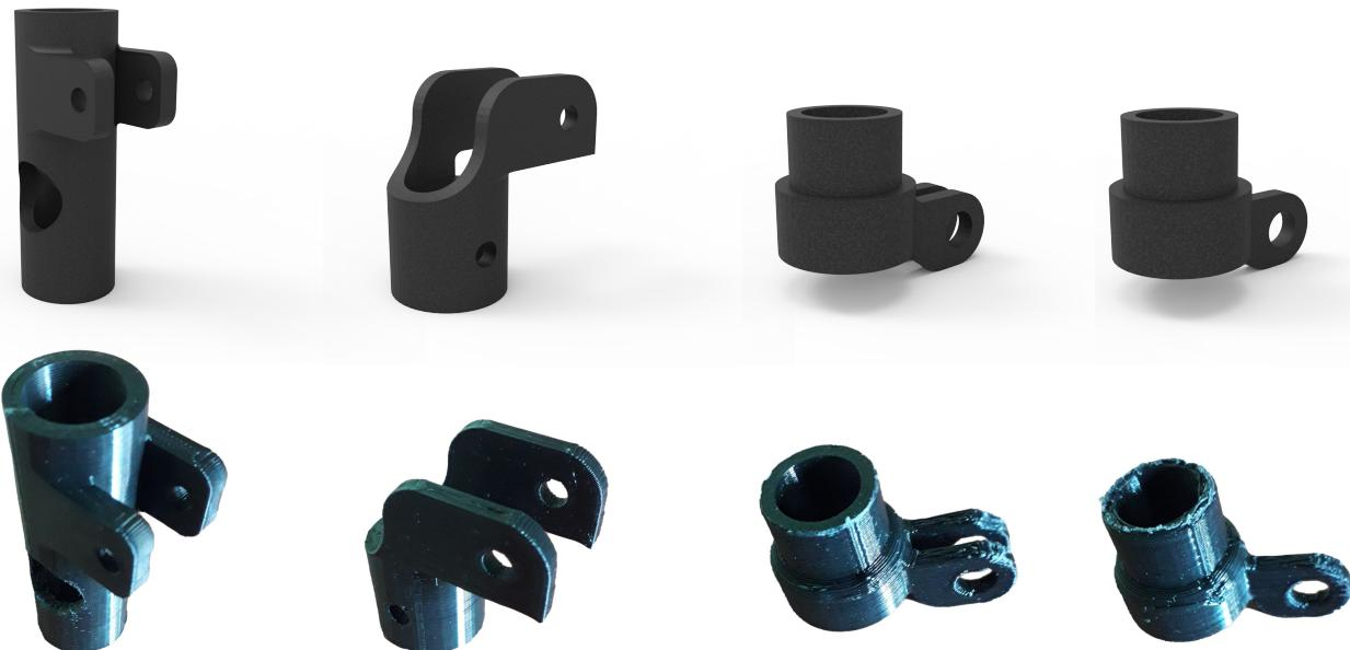
*Comparativa del modelado de las piezas y el resultado final obtenido mediante la impresión 3D.*
