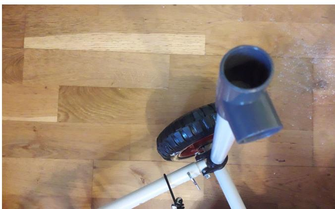
*El proceso realizado fue cortar cada perfil vertical en dos partes, que encajan con el codo, obteniendo una zona horizontal de apoyo. Se consigue además una mayor firmeza y estabilidad del carro.*
