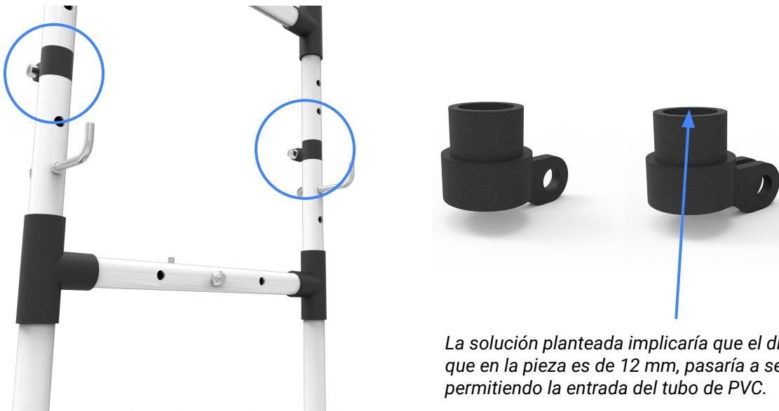
*La solución planteada implicaría que el diámetro interior, que en la pieza es de 12 mm, pasaría a ser de 20 mm, permitiendo la entrada del tubo de PVC.*
