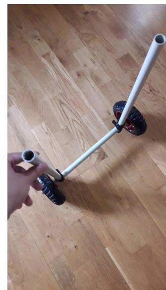
*Son colocados los perfiles base a una distancia simétrica con las ruedas y marcan la que será la distancia general entre todos los elementos que se colocan después.*
