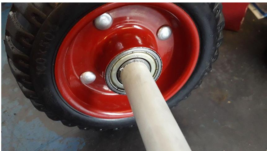
Resultado final de las ruedas con su eje y el recubrimiento con el perfil de PVC.
