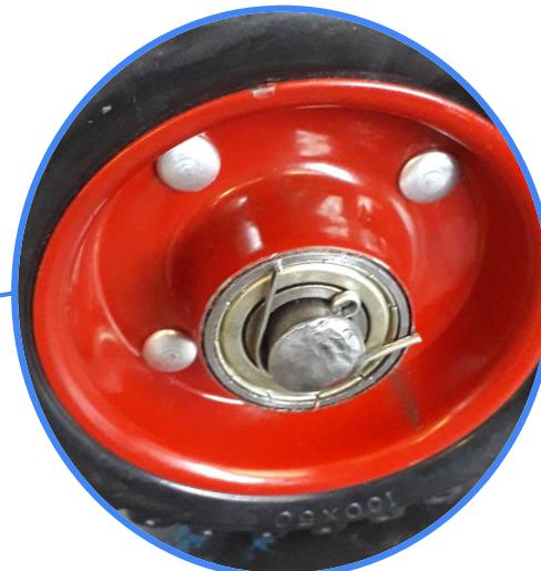
*El pasador se introduce por los orificios realizados anteriormente.*
