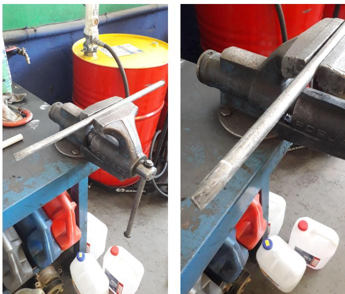
*Se emplea una barra de acero reciclada, en la que se marca las medidas para el hueco requerido entre las ruedas y se corta con un radial.*
