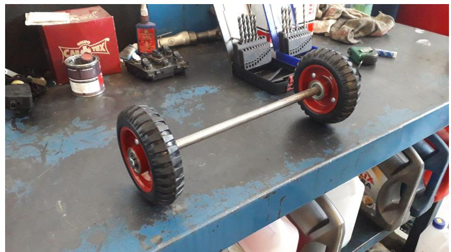
*Se ajusta la barra en el torno, y se taladran ambos extremos. Después, se introduce ya la barra en el eje de las ruedas.*
