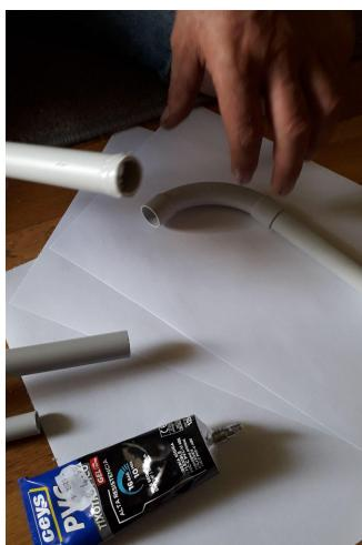
*Para la superficie horizontal, que supondrá la plataforma de apoyo de elementos en el carro, se emplean dos codos de 90º que se unen mediante adhesivos, consiguiendo un proceso en el que no se emplea ninguna máquina especializada, únicamente el corte de los perfiles y su conexión.*
