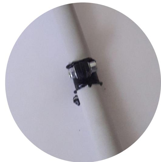
*Al tener unas dimensiones muy pequeñas, estas piezas tiene una ligera curva en la parte que encaja con los tubos de PVC y por ello se emplea adhesivo para conseguir una conexión más segura.*
