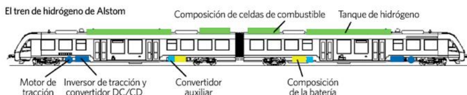
Figura 2. Partes del tren de hidrógeno de Alstom. [4]
