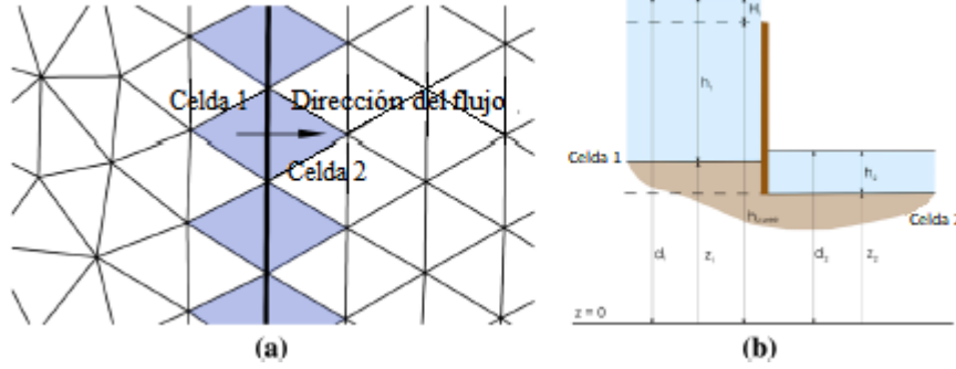
Figura A.1: Diagrama del flujo a través de un dique en una malla triangular 2D. Vista en planta (a) y vista lateral (b).
