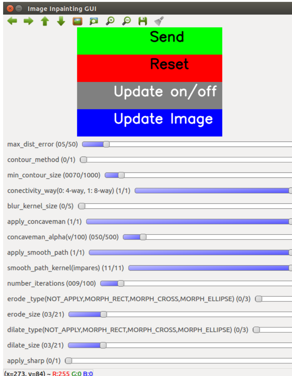
Figura E.1: Interfaz de usuario del programa image_inpainting_gui que permite configurar los valores de los parámetros del segundo demostrador (capítulo 8) a través de trackbars . También dispone de cuatro botones para enviar comandos al demostrador.
