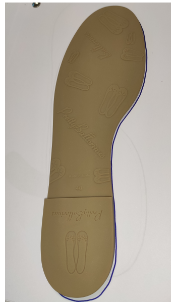
(b) Suela colocada sobre el dibujo realizado por el robot. Se aprecia que la forma del objeto y el dibujo del contorno coinciden.
