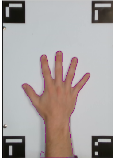
Figura 8.9: Contorno extraído del antebrazo de una persona, dibujado, en color violeta, sobre la imagen rectificadas. Se aprecia que en la parte inferior izquierda hay un fragmento de sombra incluido como parte del contorno.
