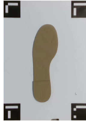
(b) Imagen rectificadora aplicando un cambio de perspectiva sobre la imagen original.
