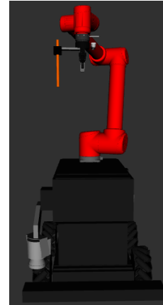
(b) Posición para facilitar la percepción con la cámara de las marcas ArUco situadas sobre la superficie de trabajo, llamada “see_aruco”.
