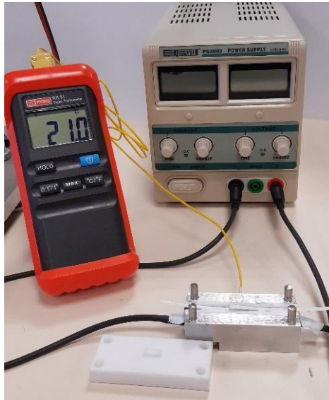
Figura 12: Utillaje conectado a la fuente de alimentación que alimenta a la resistencia, con el termopar que muestra la temperatura que va alcanzado el proceso.
