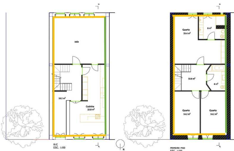
Figura 2.7 - Envolvente marcada na planta.
