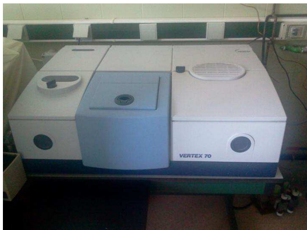
Figura 3.13 – Espectrofotómetro “FT-NIR Spectrometer Vertex 70”
