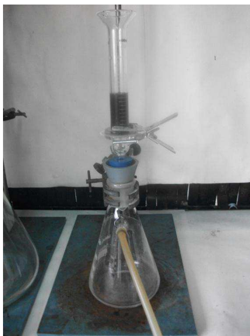
Figura 3.27 –Filtrado de una dispersión de nanotubos
