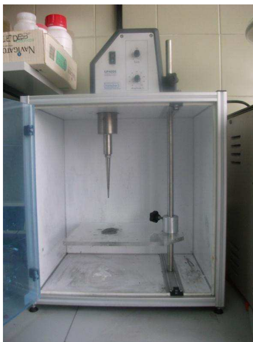
Figura 3.10 – Punta de ultrasonidos “HIELSCHER, UP400S”
