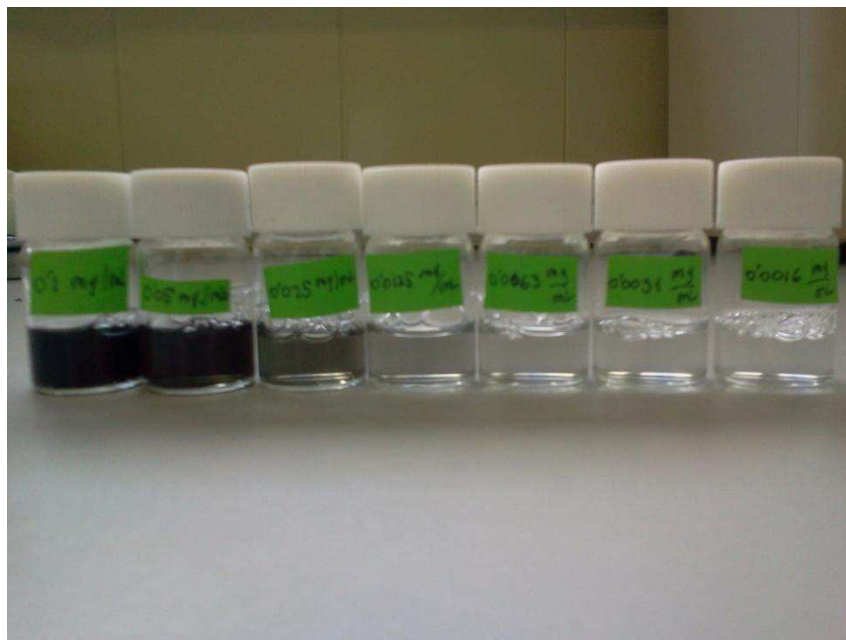
Figura 3.22 –Una serie de diluciones de una dispersión de SWNT preparadas para obtener la recta de calibrado.
