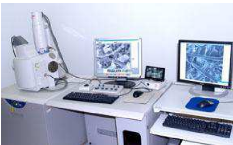
Figura 3.14 – Microscopio de barrido electrónico “SEM EDX Hitachi S-3400” (ICB-CSIC)
