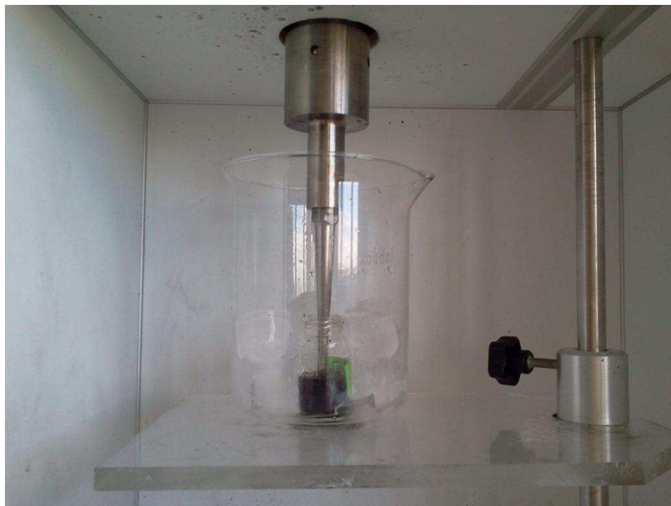
Figura 3.21 –Dispersión de nanotubos mediante ultrasonidos
