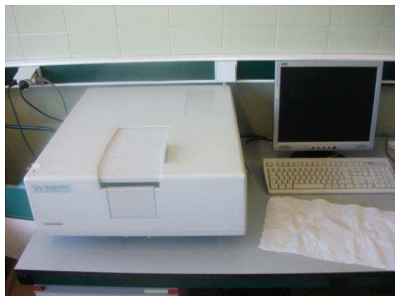
Figura 3.12 – Espectrofotómetro “SHIMADSZU, UV – 2401PC”
