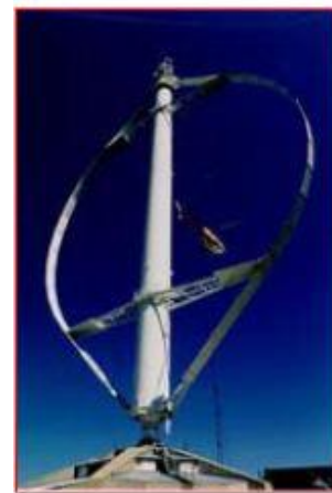
Figura 19: Aerogeneradores de eje vertical. A la izquierda tipo Savonius. A la derecha tipo Darrieus. Fuente: www.cerpch.unifei.edu.br y www.opex-energy.com
