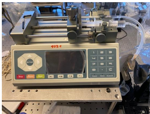
Figura 7: bomba que se utiliza para el control de los caudales.
