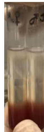
Figura 7. Tubos de centrifuga tras la recogida de las cuatro fracciones de gotas lipídicas resultantes
