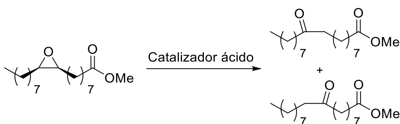
Esquema 1.24. Transposición de Meinwald del cis -9,10-epoxiestearato de metilo con un catalizador ácido (Brönsted o Lewis).
