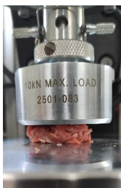
Figura 5. Texturómetro realizando un ciclo de compresión
