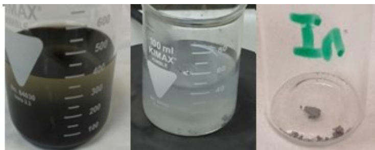
Figura 3.24. Precipitación con zinc (izq.), tratamiento con H 2 O 2 (centro) e indio metal (dcha.)
