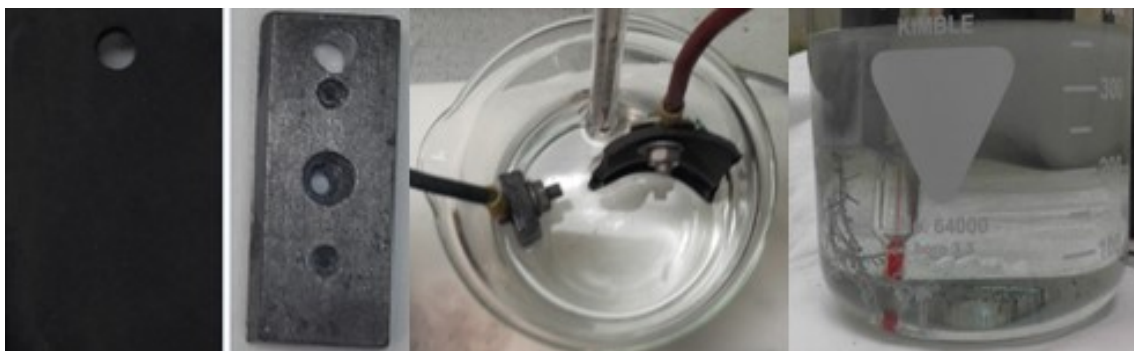
Figura 3.20. Ánodo y cátodo (izq.), celda electrolítica (centro) y deposición de zinc (dcha.)
