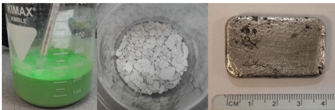
Figura 3.16. Óxidos metálicos en HCl (izq.), SnO 2 filtrado (centro) y Sn (dcha.).
