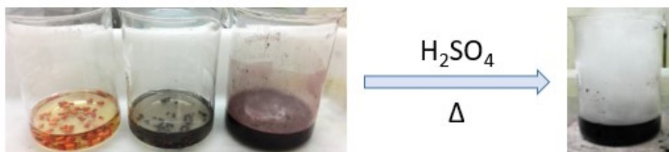
Figura 2.15. Tratamiento con ácido sulfúrico caliente de condensadores enteros (izq.), fragmentados (centro) y pulverizados (dcha.).
