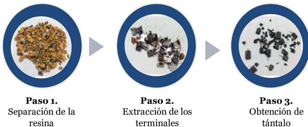
Figura 2.7. Resina, terminales metálicos y núcleos de tántalo de condensadores. 5, 43
