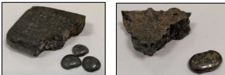
Figura 2.14. Escoria y aleación metálica de la fundición de los condensadores enteros (izq.) y pulverizados (dcha.).
