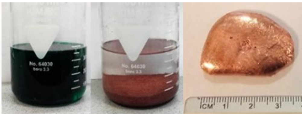
Figura 3.18. Disolución de los iones de cobre y zinc (izq.), precipitación de cobre (centro) y cobre metálico (dcha.).
