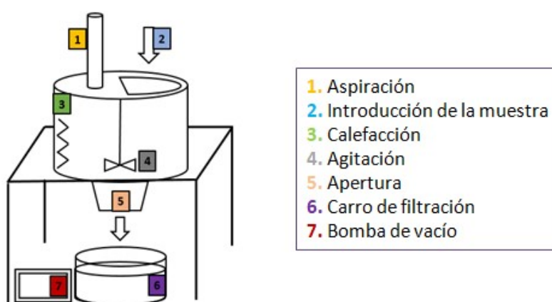
Figura 3.39. Reactor para la reducción del dióxido de selenio.
