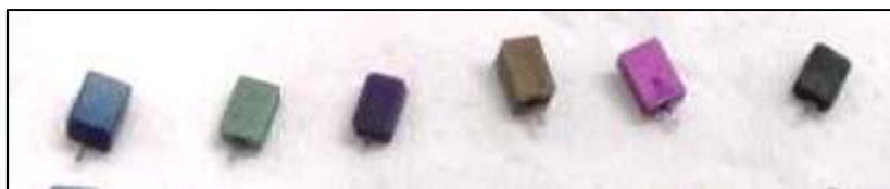
Figura 2.17. Núcleos de tántalo recuperados tras tratamiento con H_2SO_4 y HNO_3 .
