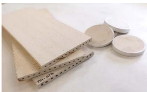
Figura II-2. Membranas acanaladas rectangulares y circulares macizas
