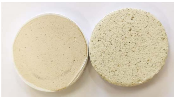
Figura II-7. Presencia de defectos en la composición MHC (derecha) frente a la membrana MCA (izquierda) que presenta una superficie lisa y sin grietas.
