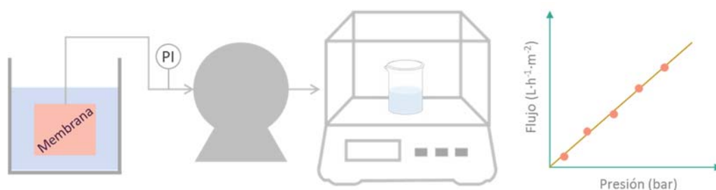
Figura II-6. Instalación para medir la permeación al agua de las membranas
