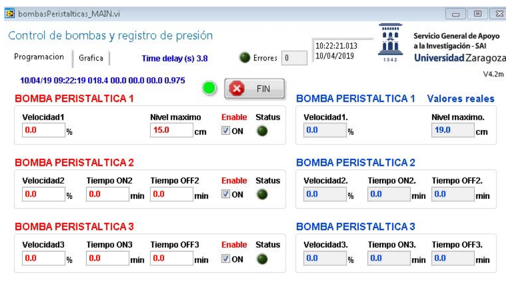
Figura III-7. Interfaz del software diseñado para el control de la planta de MBR
