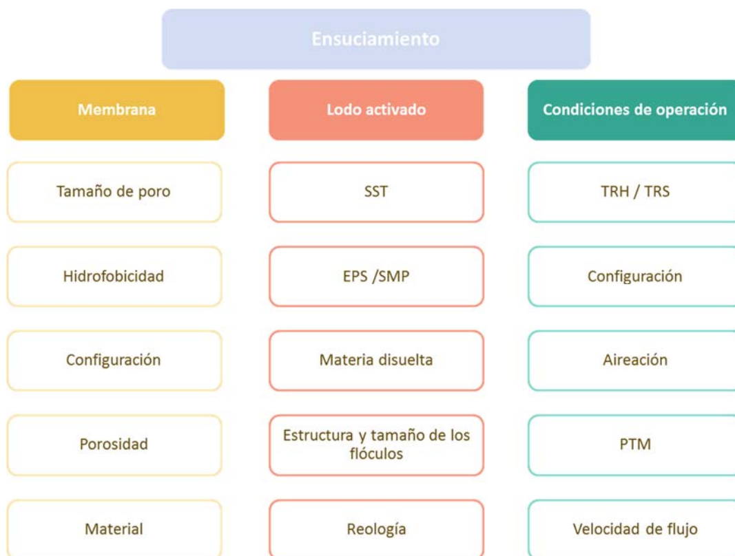
Figura I-13. Esquema de las distintas causas del ensuciamiento en los MBR
