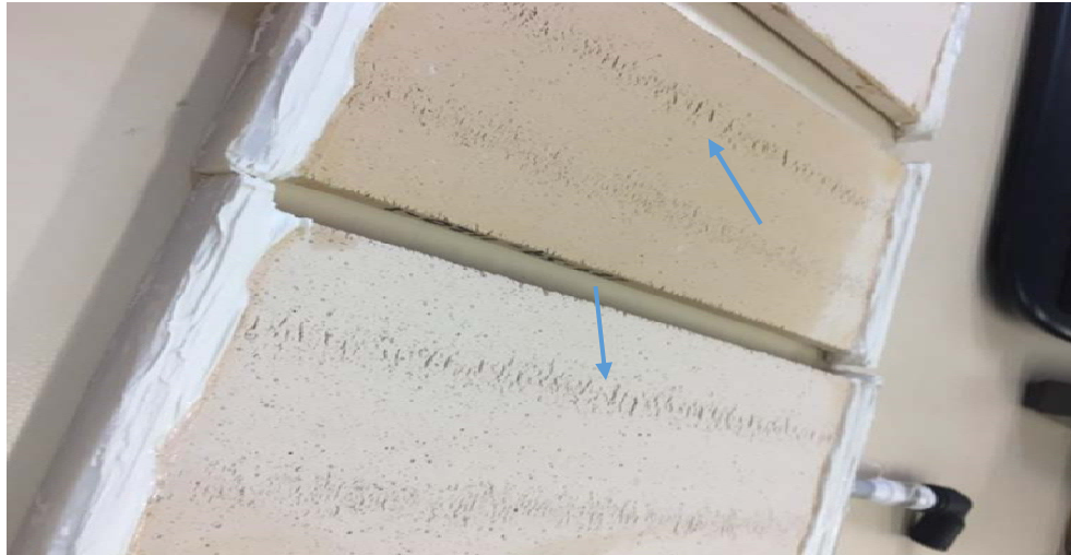
Figura II-11. Defectos de extrusión de las membranas cerámicas acanaladas
