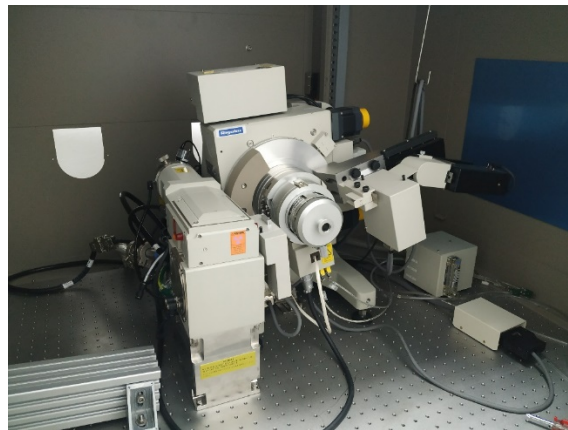
Imagen 2.2. Equipo Rayos X provisto de un difractómetro D-Max Rigaku, Ru300, con un ánodo rotante de Cu.
