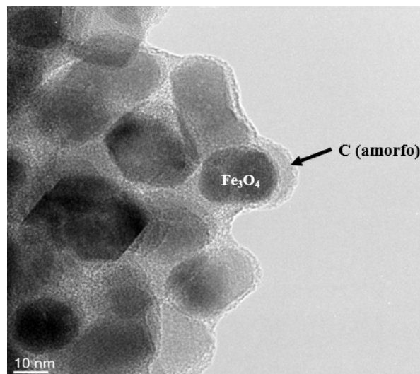
Figura 3.20. Imagen HRTEM de las nanopartículas de Fe_3O_4@C donde se observan varios núcleos de Fe_3O_4/\gamma-Fe_2O_3 completamente encapsulados por una capa de carbono amorfo.
