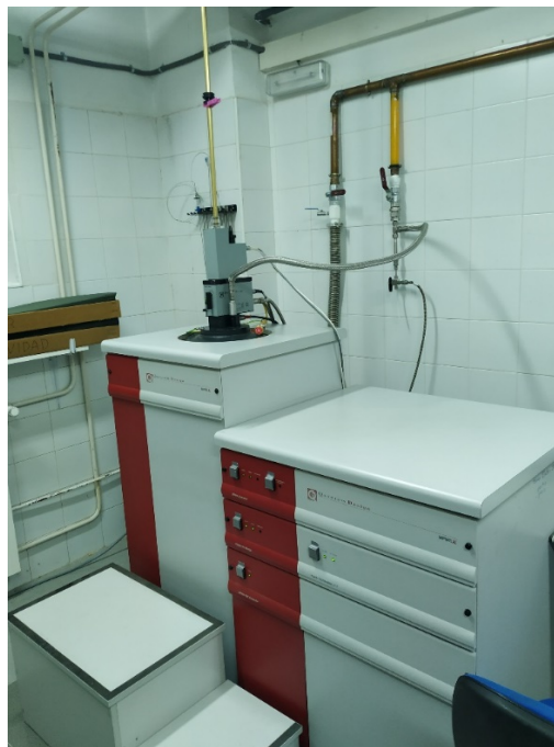
Imagen 2.3. Magnetómetro SQUID MPMS-XL, Quantum Design, del Servicio de Medidas Físicas, del Servicio General de Apoyo a la Investigación de la Universidad de Zaragoza.
