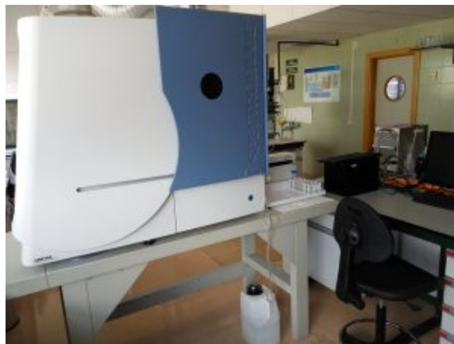
Imagen 2.10. Equipo Spectroblue de la casa Ametek para el análisis ICP-OES (ref: Aylón 2016).
