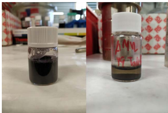
Imagen 6.4. Imagen de las nanopartículas de Fe_{2.2}C funcionalizadas con ácido caféico/ NH_2 -PEG- NH_2 . A la izquierda, se observa la muestra inmediatamente después de la funcionalización de las nanopartículas. A la derecha se observa la muestra a los pocos minutos, en la que las nanopartículas han precipitado.
