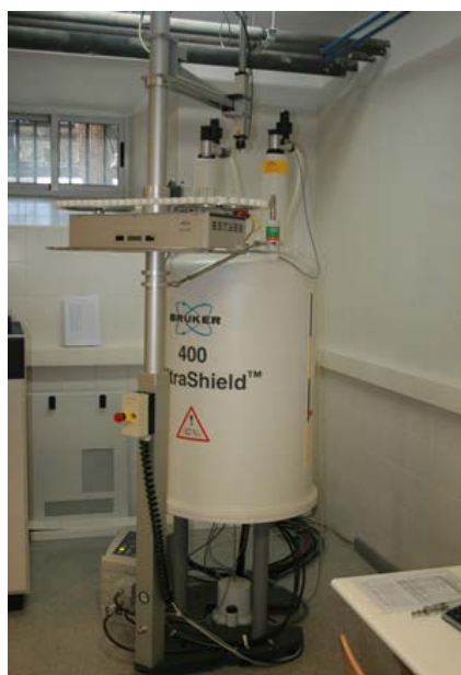
Imagen 2.11. Equipo Bruker AVANCE 400 MHz del Servicio de Resonancia Magnética Nuclear del Instituto de Síntesis Química y Catálisis Homogénea (ISQCH) de la Universidad de Zaragoza (ref: Zaragoza, 2020).
