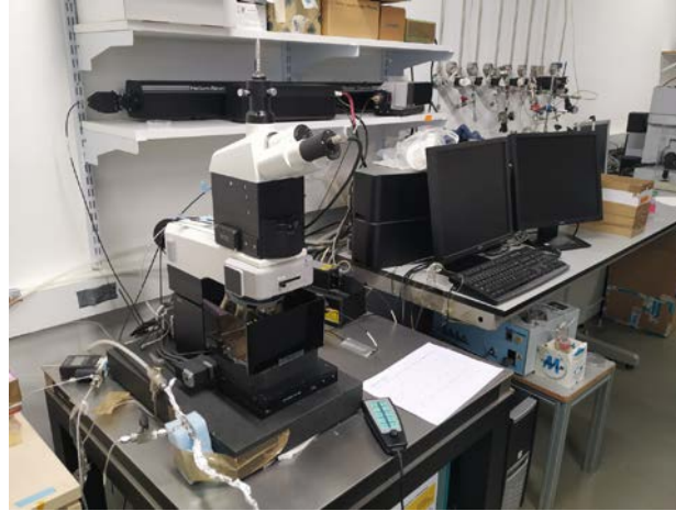
Imagen 2.7. Equipo Raman Confocal Alpha 300 M+ de WITec.
