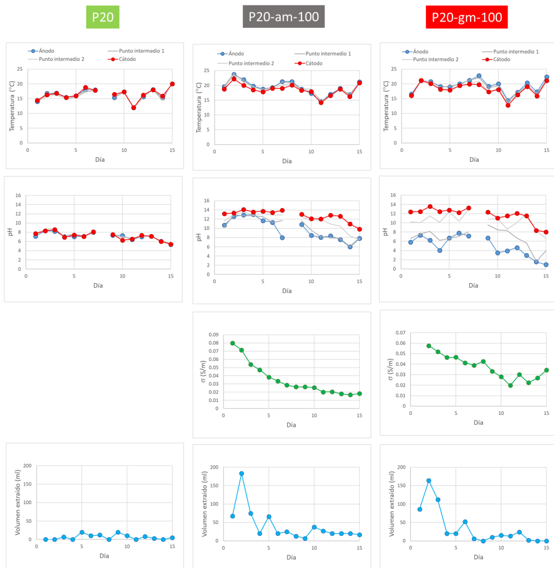
Figura 19. Resultados de la monitorización periódica de los experimentos de la Tanda 1. El experimento P20 es el experimento "blanco", durante el cual no se pasó corriente eléctrica por los electrodos (por eso no hay gráfica resistividad-tiempo).
