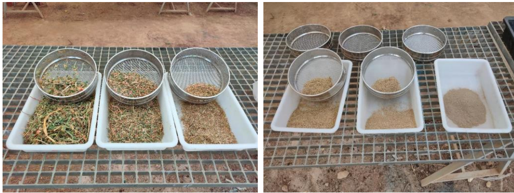
Figura 25. De izquierda a derecha, tamices con apertura de malla 4 mm, 2 mm, 1 mm, 500 µm y 250 µm con sus respectivos residuos y resto de residuo inferior a 250 µm.
