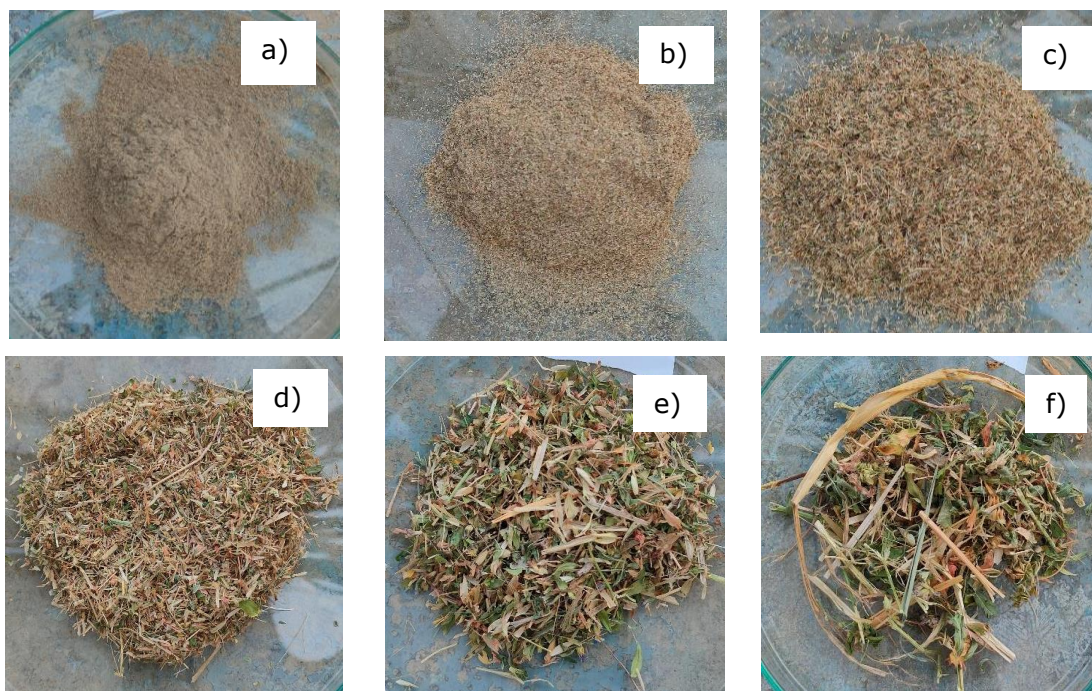
Figura 26. Muestras de los 6 tamaños tamizados. a) <250 µm; b) 250 µm; c) 500 µm; d) 1 mm; e) 2 mm; f) 4 mm.
