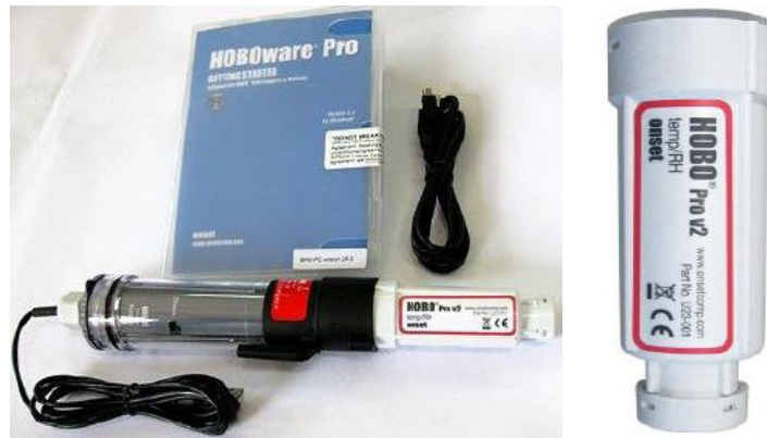
Figura 20. (Izquierda) Software Hoboware Pro y Puerto USB óptico. (Derecha) Sonda de temperatura y humedad (Hobo Pro v2).
