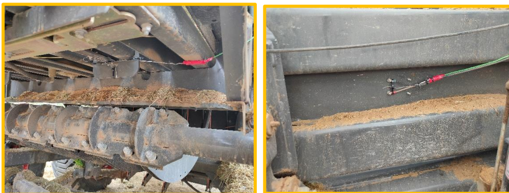
Imagen IV.33. (Izq) Sonda canal inferior del canal de compresión. (Dch) Sonda en el canal lateral del canal de compresión.
