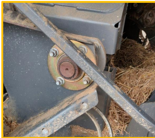
Imagen IV.10. (Izq) Sonda en el cojinete izquierdo del eje pick up. (Dch) Sonda cojinete derecho del eje pick up.
