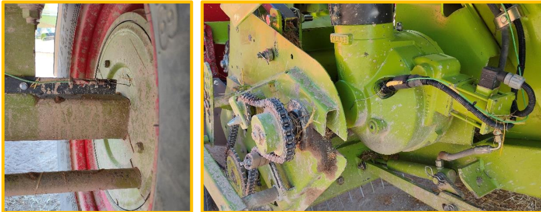
Imagen IV.26. (Izq) Sonda del tambor de freno. (Dch) Sonda de la transmisión del pick up.
