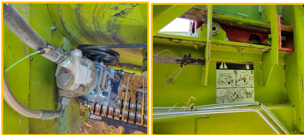
Imagen IV.27. (Izq) Sonda de la bomba hidráulica. (Dch) Sonda del canal de compresión.
