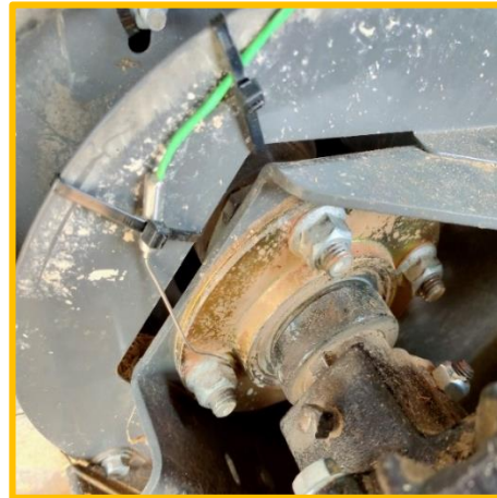
Imagen IV.10. (Izq) Sonda en el cojinete izquierdo del eje pick up. (Dch) Sonda cojinete derecho del eje pick up.
