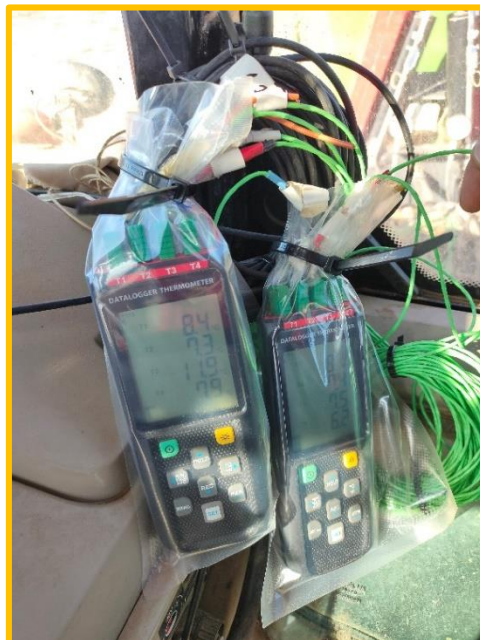
Imagen IV.34. Dataloggers instalados en cabina del tractor para el registro de los datos en la campaña de maíz.
