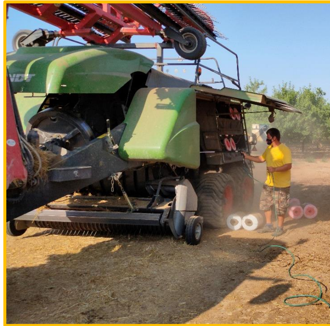
Imagen IV.12. Mantenimiento de la empacadora mediante soplado del residuo y reposición de cuerda
