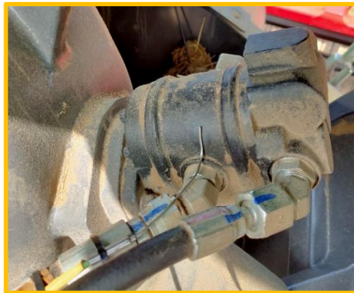
Imagen IV.11. (Izq) Sonda del freno del embrague. (Dch) sonda de la bomba hidráulica.
