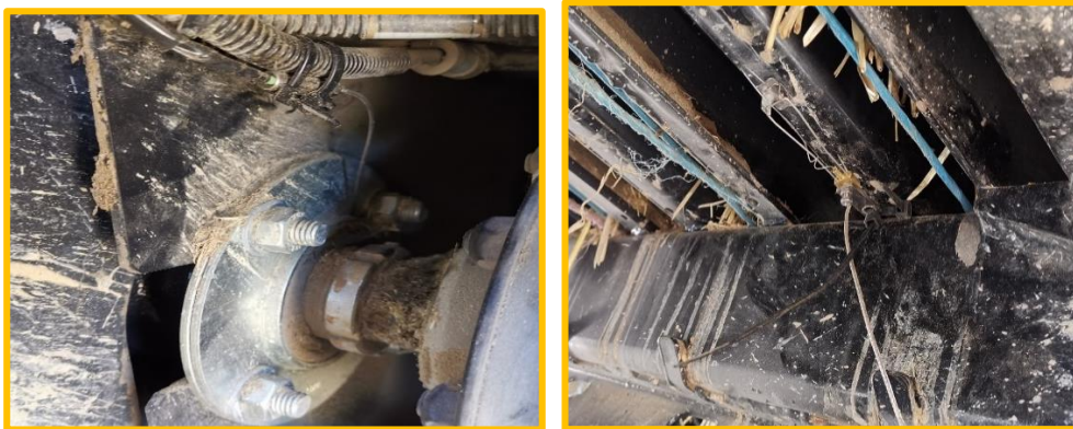
Imagen IV.16. (Izq) Sonda del cojinete del pick up. (Dch) Sonda canal de compresión.
