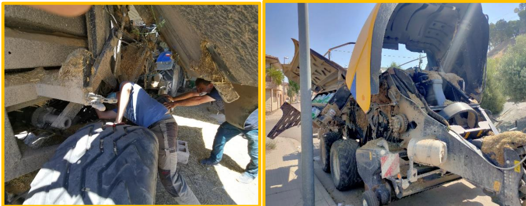
Imagen IV.17. (Izq) Operación de montaje de sondas. (Dch) Empacadora en el momento desmontaje.
