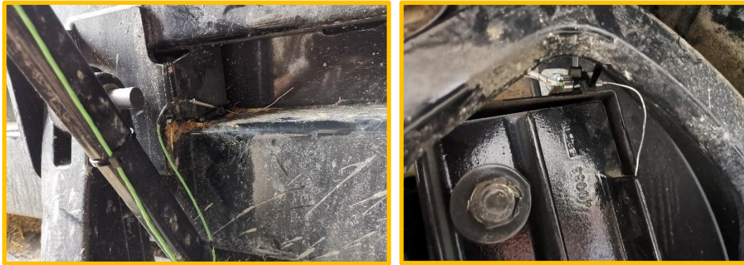
Imagen IV.22. (Dch) Sonda del canal de compresión. (Izq) Sonda del freno del alimentador.
