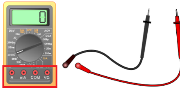
Ilustración 21. Conexión cables polímetro. Fuente Tecno12-18
