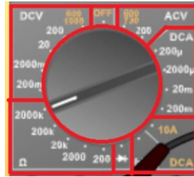
Ilustración 22. Selector polímetro. Fuente Tecno12-18
