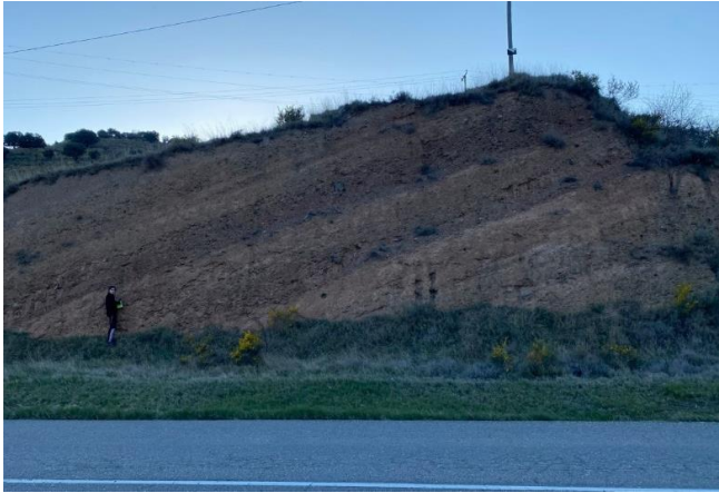
Imagen 13: Cuaternario deslizado, buzando en otra dirección 101/30S, paralelo a la carretera
