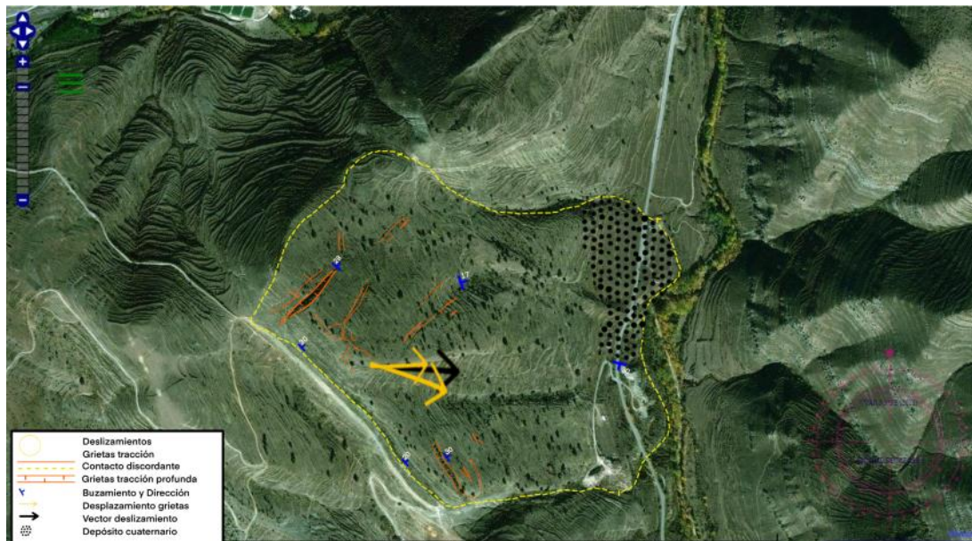
Imagen 8: Esquema cartográfico de la masa total afectada (Unos 70 hm 2 ), con direcciones y buzamientos.
