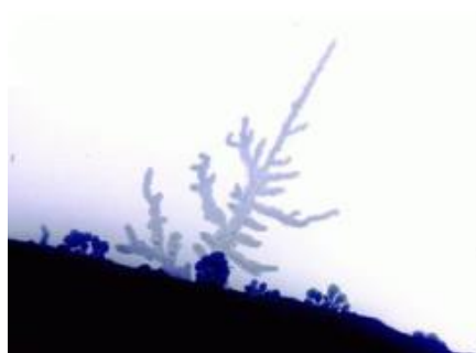
Figura 2. Imagen de microscopio óptico representando una dendrita de Li [26]
