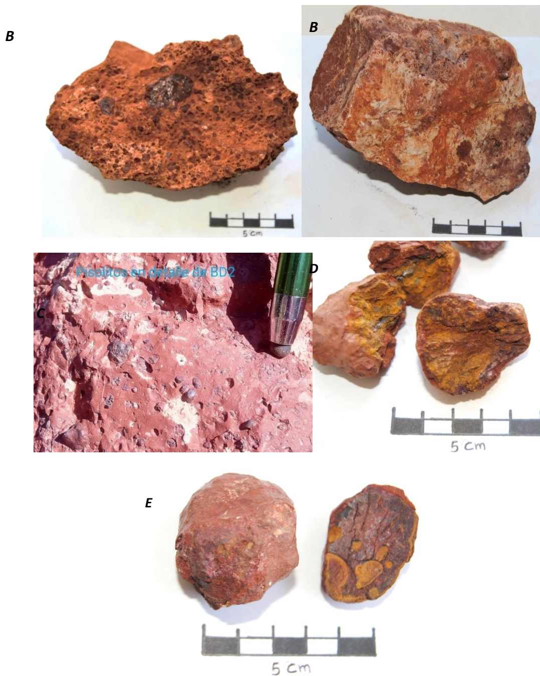
Figura 6.- A) Muestra BD-5: bauxita con textura pisolítica donde se pueden observar numerosos pisolitos ferruginizados de diferentes tamaños y zonas ferruginosas. B) Muestra BD-0: arcilla bauxítica densa y compacta, que presenta costras y venas blanquecinas de carácter superficial. C) pisolitos granates en la matriz arcillosa. D) Muestra BD-nod: nódulos irregulares con coloraciones amarillas debido a la alta presencia de goethita. E) Muestra BD-3: nódulos rojos ovalados, el interior muestra colores amarillos y negros, éste último debido a la elevada presencia de hematites.
