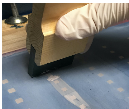
Figura 10: Proceso screen printing
