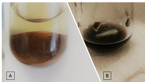
Figura 18: Sistema catalítico recuperado (A) y sistema catalítico original (B).
