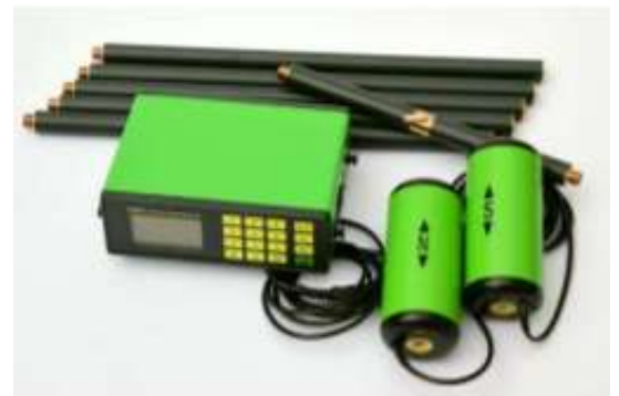
Fig. 3- Magnetómetro fijo utilizado, modelo PMG-2 de de SatisGeo.
