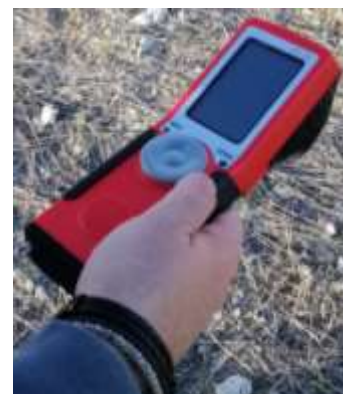
Fig. 5- Susceptómetro de mano KT-20.
