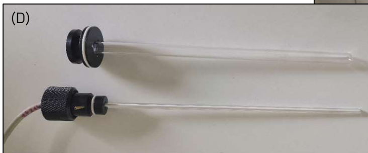
(D) Tubo de ensayo con varilla termosensora CS-L (AGICO, 2003).
