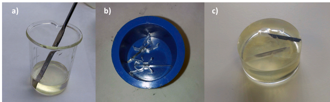
Figura B3.4. Proceso de embutición de las muestras. a) Preparación de la resina polimérica. b) Colocación de las muestras en el embutidor. c) Muestra ya curada.
