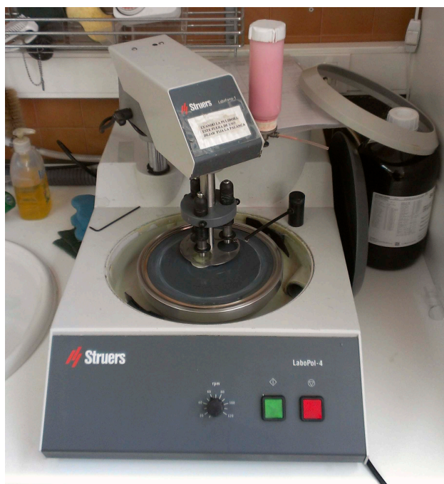
Figura B3.5. Muestra en proceso de pulido.
