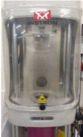
Figura 14 Reómetro capilar Instron Ceast sr20
