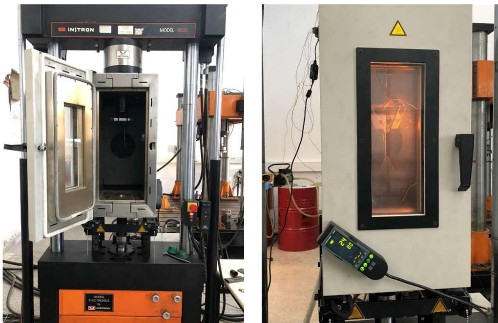
Figura 42 Caracterización de las muestras a 50°C y 80°C con cámara climática.
