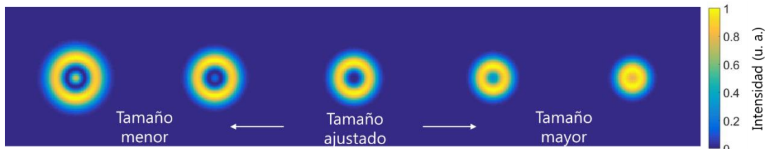
Figura 4.32 Representación del cambio en la distribución de intensidad del módulo de \tilde{W}_S correspondiente a la máscara del modo LP_{02} , según su tamaño con respecto al campo incidente, suponiendo un campo incidente proporcional al del modo LP_{01} . Las imágenes se corresponden con unos aumentos de 0.72, 0.86, 1.00, 1.21 y 1.42 respectivamente.
